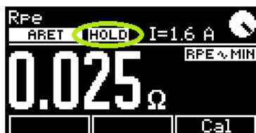
Obrázek 41: Zablokování hodnoty měřené veličiny na displeji
