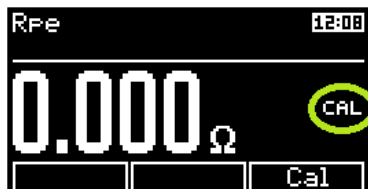
Obrázek 45: Kompenzace odporu měřicích šňůr
