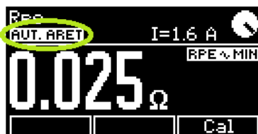
Obrázek 40: Automatická aretace tlačítka [TEST]
