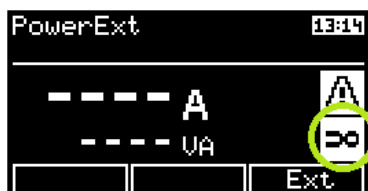
Obrázek 47: Aktivace vstupu pro externí měřicí zařízení
