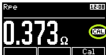
Obrázek 46: Chyba kompenzace odporu měřicích šňůr
