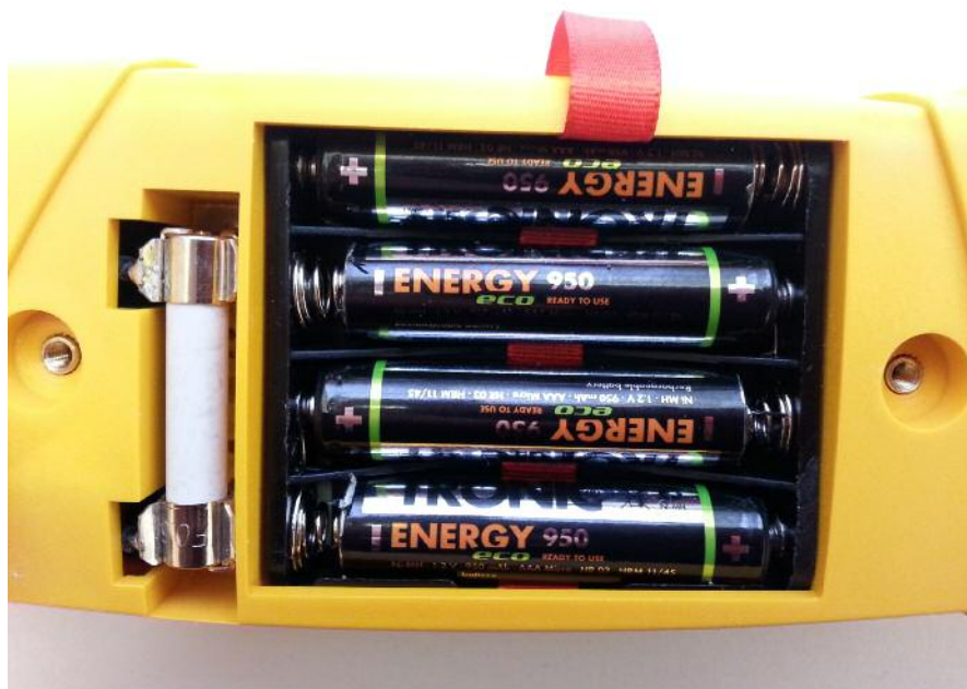
Obr. 4.1 Správná polarita napájecích článků a umístění pojistky
