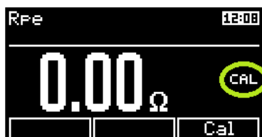
Obrázek 27: Kompenzace odporu měřicích šňůr
