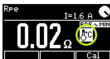
Obrázek 19: Upozornění na zahřívání vnitřních obvodů při měření Rpe
