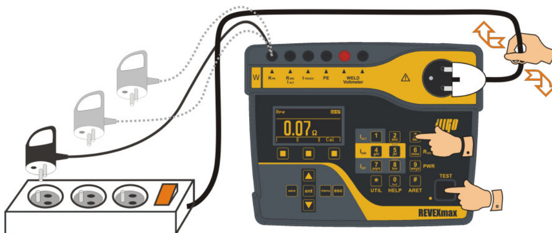
Obrázek 36: Použití adaptéru pro testování prodlužovacích přívodů
