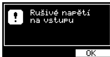
Obrázek 7: Varovné hlášení: Rušivé napětí na vstupu
