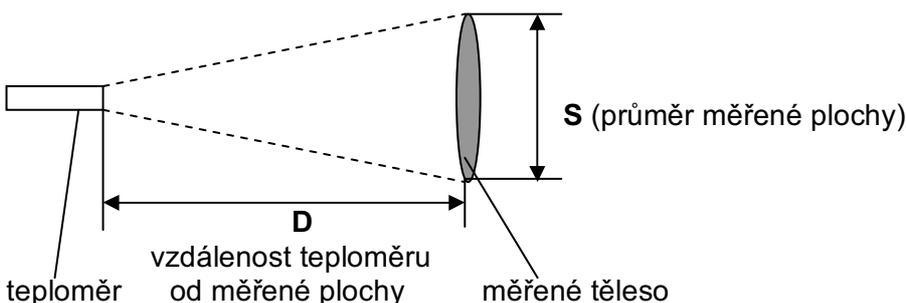
Optická charakteristika běžných teploměrů mívá hodnotu přibližně od 3:1 do 80:1 (existují však i typy s D:S např. jen 1:1 nebo naopak 180:1).
