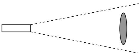
Zobrazená teplota pak bude záviset na tom, jaký předmět je umístěn za měřeným tělesem a jakou má tento předmět teplotu (může to být např. zeď nebo cokoliv jiného). Zobrazená teplota bude někde mezi teplotou měřeného tělesa a teplotou předmětu (např. zdi) za ním.
