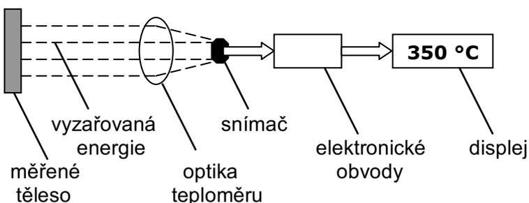
Jednotlivé části teploměru:
