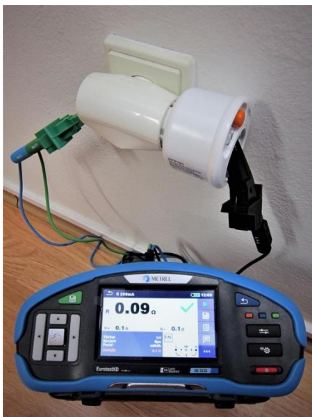
Obr. 3 – Měření R_{PE} trojpólového PRCD
